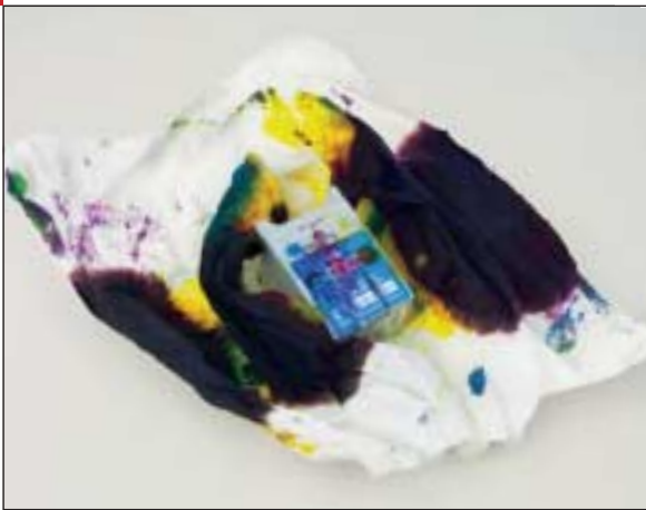
AUSLAUFEN UND AUSBLEICHEN: Nachgefüllte Patronen können beim Transport auslaufen. Spezielle Clips als Auslaufschutz gibt es ab zwei Euro. Die nachgefüllte Tinte blich in einigen Fällen bei simuliertem Sonnenlicht im Labor schneller aus als die Originaltinte. Die Druckqualität genügte in der Regel für private Nutzung.
